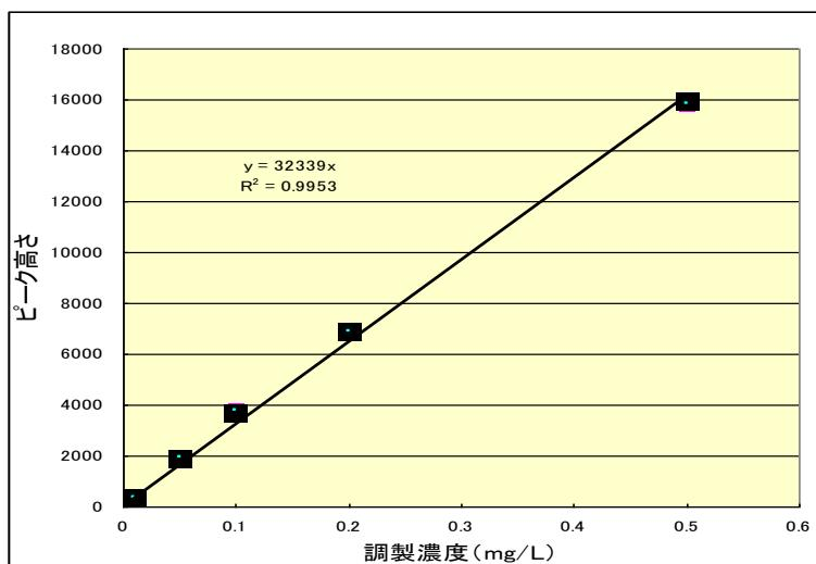
図 3.1.2.5. PCB (KC-mix) 検量線の例
