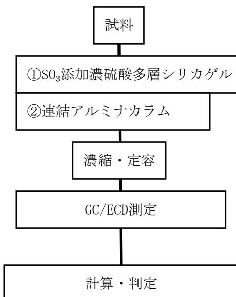
図3.1.1.1 測定操作のフロー
