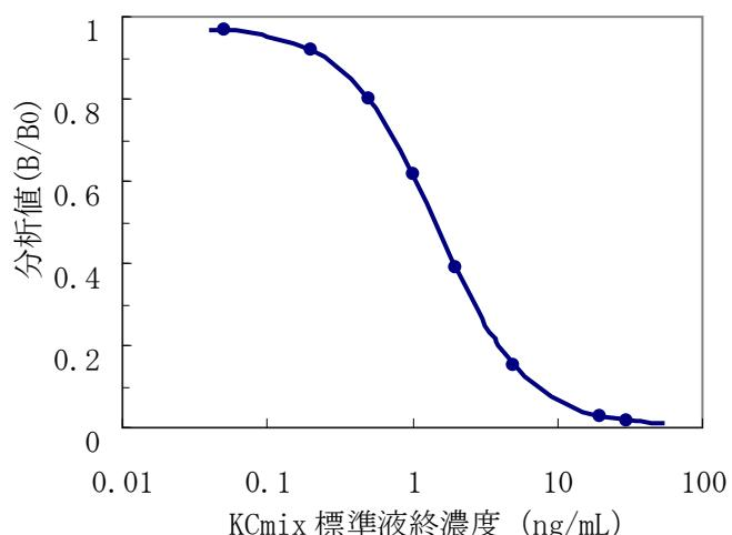
図 3.3.3.3 KC-mix 標準液を用いた検量線の例
