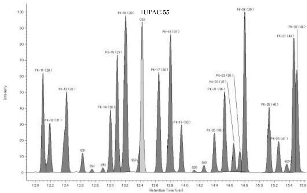
付図 2.5.1.4 標準溶液のクロマトグラム拡大(例) (絶縁油で PCB5.0mg/kg 相当)
