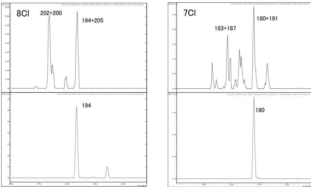
付図 2.3.1.1 GC/MS/MSによる各塩素のクロマトグラム
