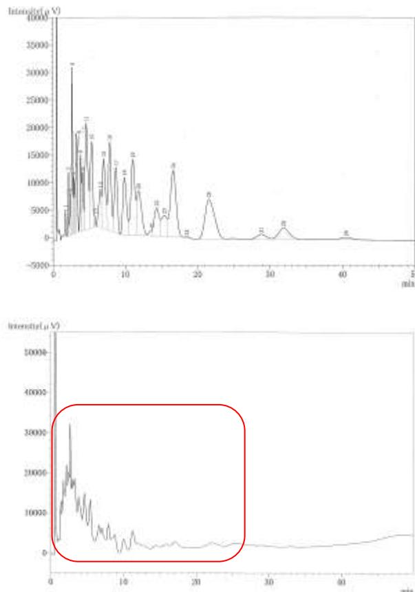
図3.1.2.2 PCB標準溶液（上）と絶縁油試料（下）のクロマトグラムの例
