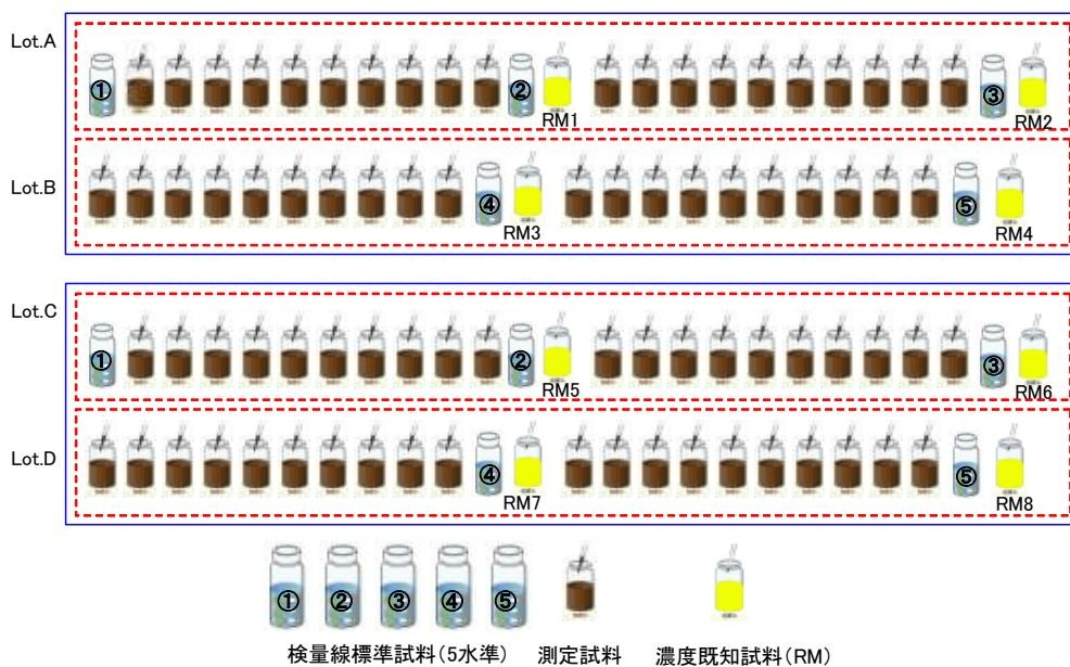
図 3.3.2.7 大量測定時の試料配置例
