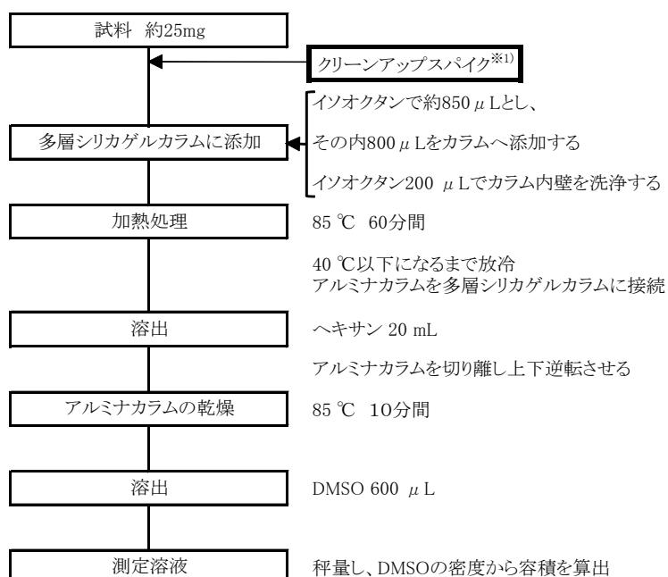
図 3.3.3.1 試料調製のフロー図
