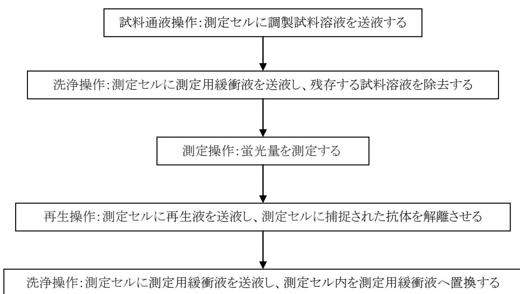
図 2.7.1.4 試料溶液測定のフロー
