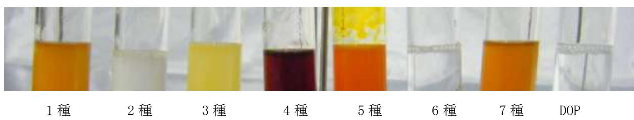
写真 2.1.1.1 硫酸処理時での各油種での色合い
