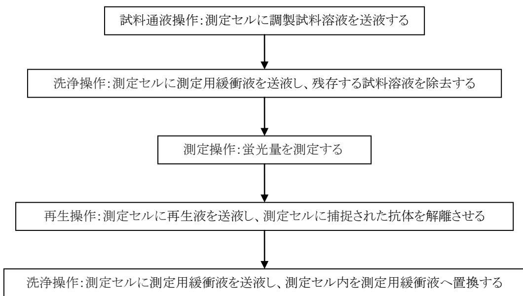
図 3.3.3.4 試料溶液測定のフロー
