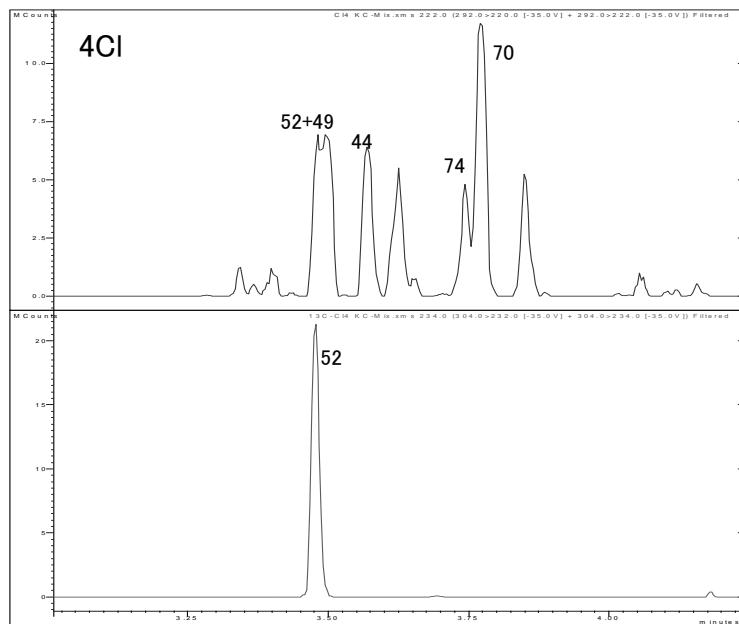
付図 2.3.1.1 GC/MS/MSによる各塩素のクロマトグラフ (上段 : ネイティブ PCB 下段 :  $^{13}\text{C}$  標識化 PCB)
