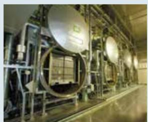
●含浸物洗浄設備 (真空加熱分離)
