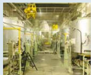
●含浸物洗浄設備 (攪拌洗浄)
